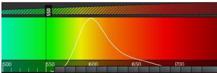
Obrázek 9 Lambda sken s excitací na 550 nm, detektor snímá rozsah od 560 do 750 nm.
