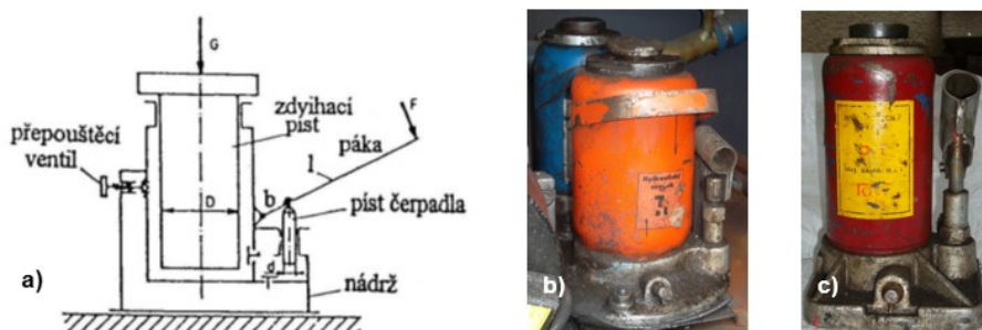
Obrázek 3: Hydraulický zvedák a) funkční schéma b) 2x 7t h. zvedák, autobus KAROSA c) 5t h. zvedák, AVIA
