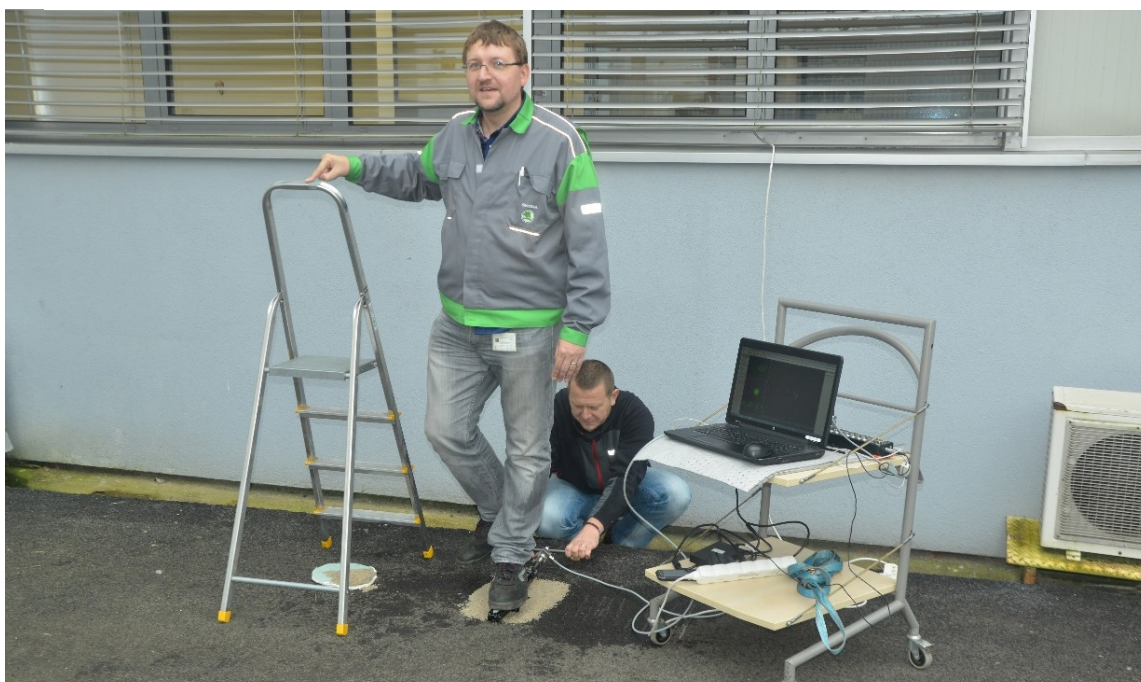
Obrázek 52: Experiment měření součinitele tření zvedáku – vozovky (třecí síla)
