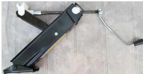
Obrázek 8: Kloubový zvedák (Rapid, Rapid Spaceback, Fabia)
