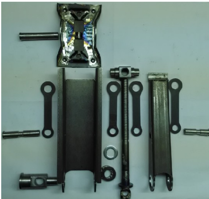
Obrázek 68: Prototyp zvedáku, rozložený stav – jednotlivé komponenty
