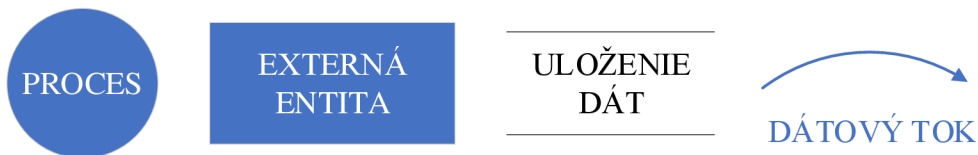
Obrázok č. 11: Symboly DFD diagramu (Upravené podľa 8, s.84)
