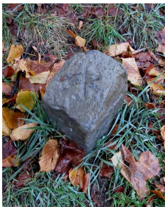
Obr. č.6 – Stabilizace kamenným hranolem
