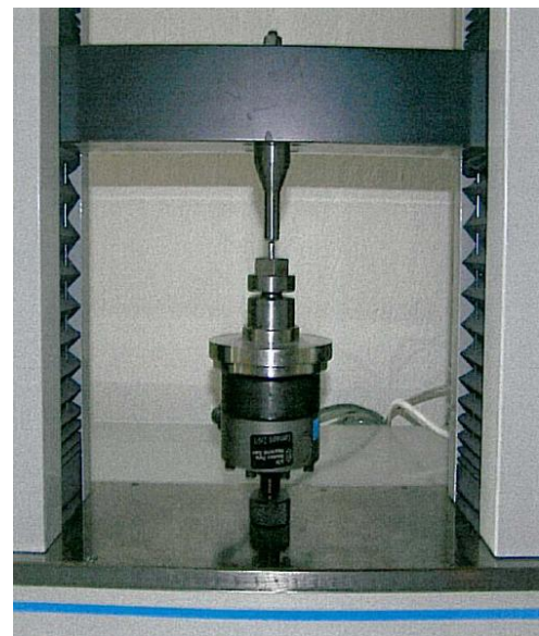
Obr. 4.5 Uspořádání přípravku pro upnutí zkušební vzorku (vlevo) a jeho umístění do rámu zkušebního stroje (vpravo) [15]
