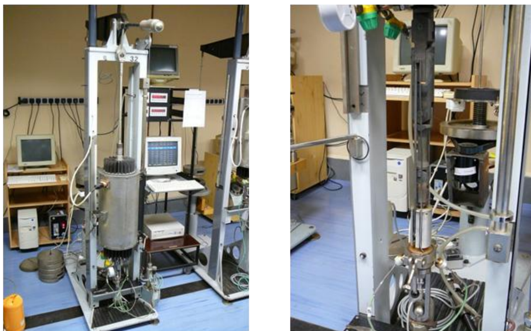
Obr. 5.3 Upravený creepový stroj pro zkoušení SPT
