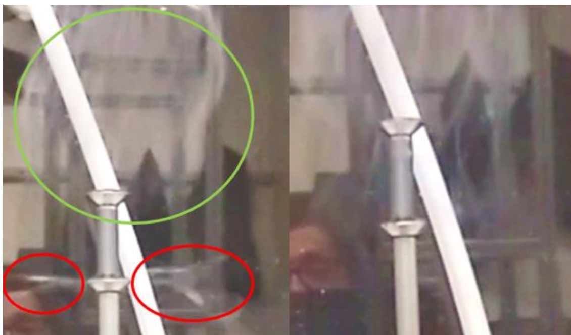
Obrázek 6.17 příklad nestabilního zvlákňování ze spodního stupně (vlevo, červený detail) a stabilního zvlákňování z prvního stupně (vlevo zelený detail), příklad stabilního zvlákňování z dvoustupňové elektrody (vpravo)
