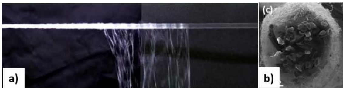
Obr. 2.5 a) Záznam nanášení nanovláken na balónující jádro [16], b) SEM snímek příčného řezu jádrové nanopříze [16]
