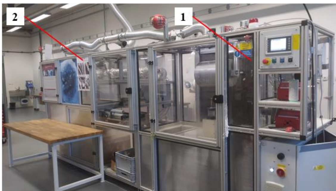
Obrázek I.I Komorový Přízový Spinner, (1) zvláknovací sekce, (2) sušící a navíjecí sekce
