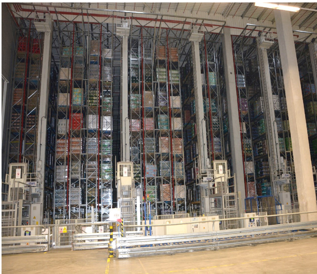
Obr. 2.4 Automatický zakladač (HRL)
