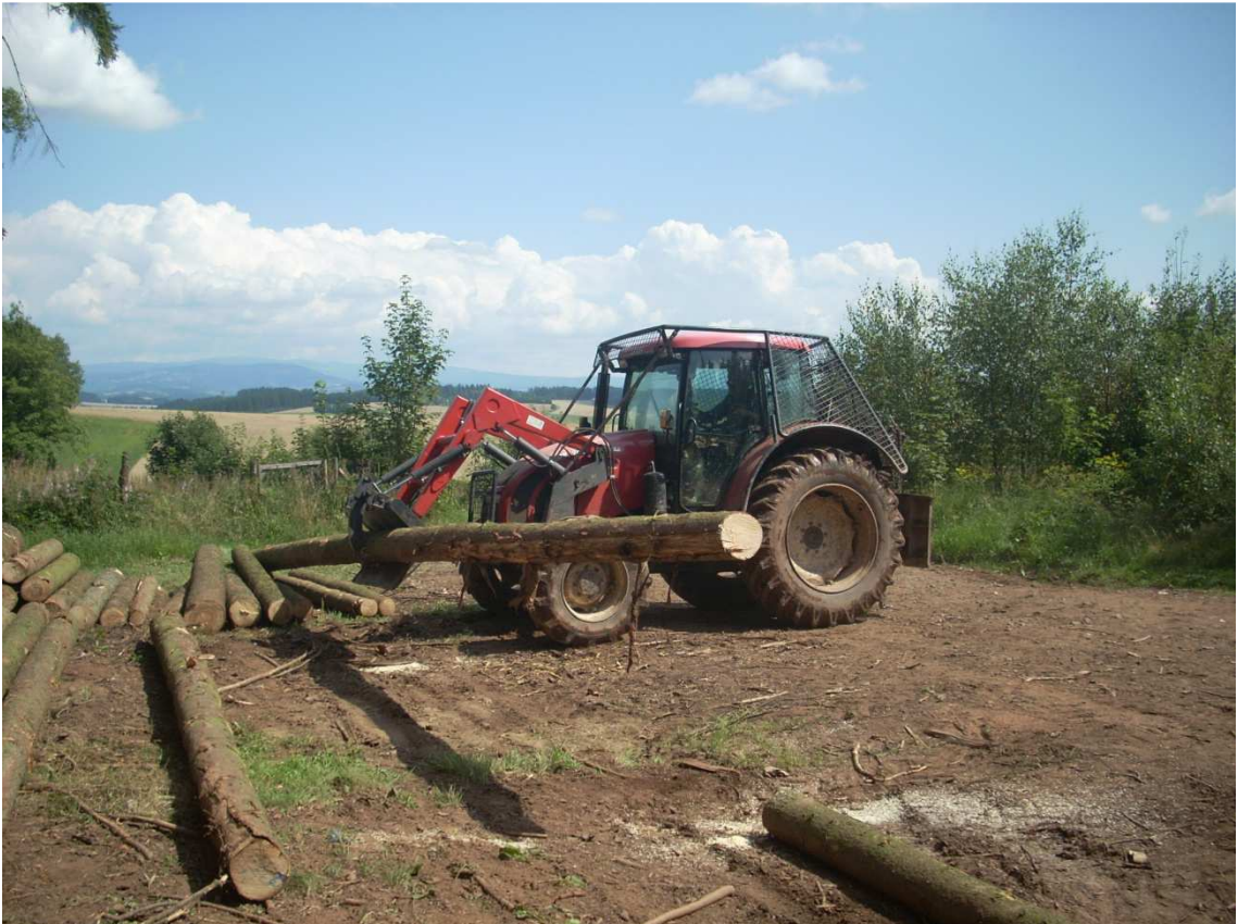
Obr. 3: Ukázka práce UKT při skládkování kmenových výřezů
