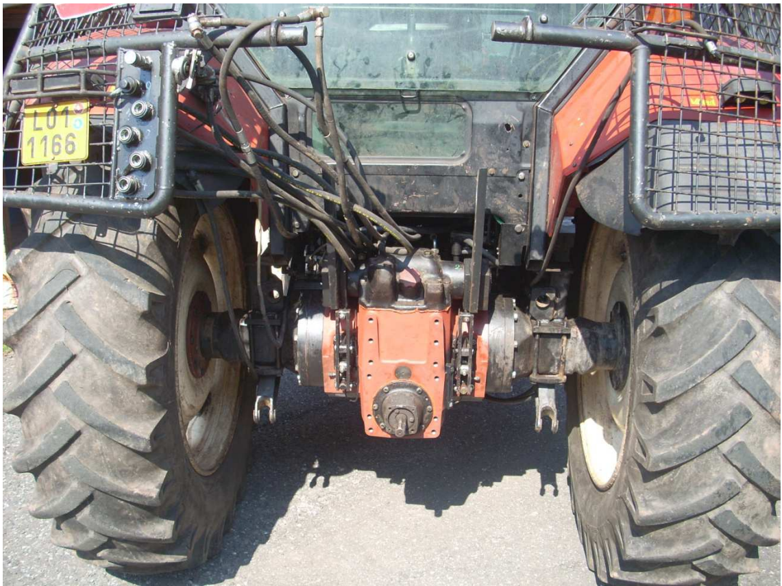
Obr. 2: Demontovaný přibližovací štít a naviják
