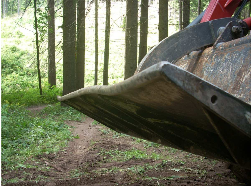
Obr. 7: Břit žlabu rampovače
