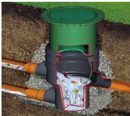
Obrázek č. 5: Filtrační koš v tělese filtru (Dvořáková D., 2007a)
