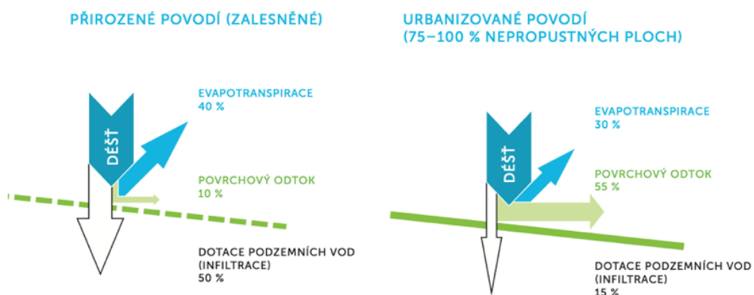
Obrázek č. 1: Porovnání odtoku srážkových vod v přirozeném a urbanizovaném povodí (Vítek et al. 2015)
