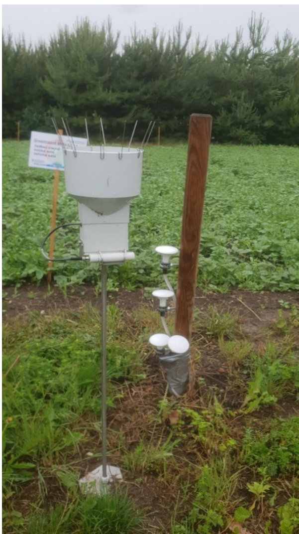
Obrázek 5: Stanoviště F1 se sondami a srážkoměrem (foto autor 2022).
