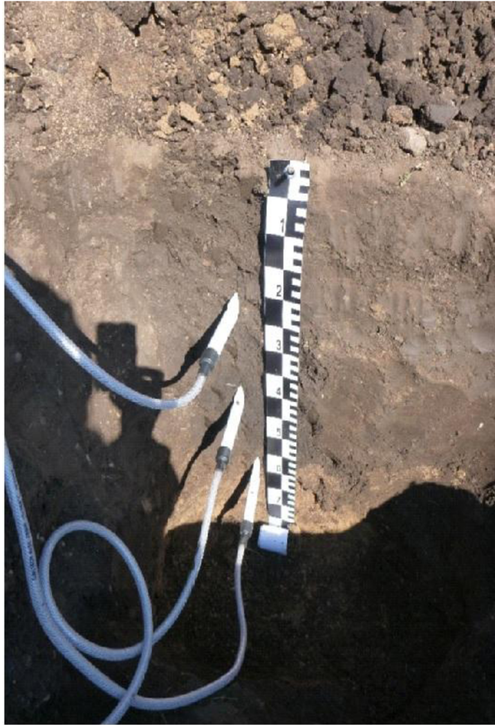
Obrázek 13: Osazení sond s vyvedením nad povrch (zdroj: VÚMOP © 2022).
