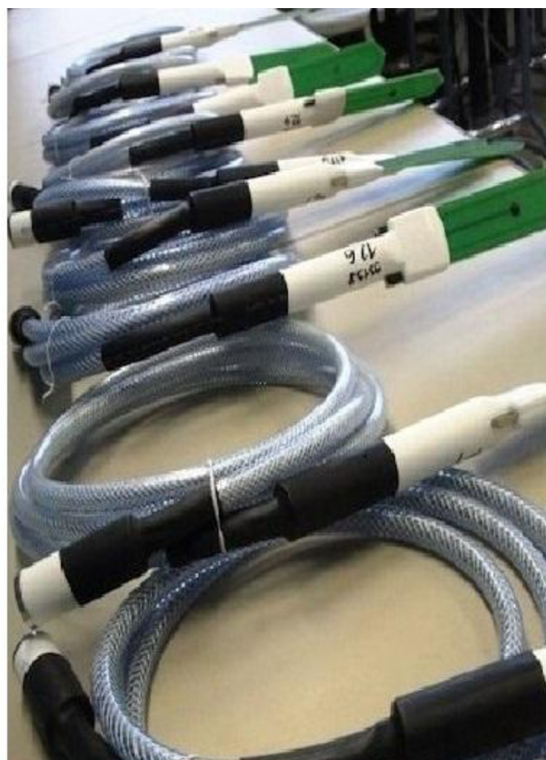
Obrázek 11: Sonda TOMST TMS-4 s popisem a Obrázek 12: Vlhkostní sonda TOMST TMS-4 osazená kabelem pro zakopávání (zdroj: Tomst s.r.o., upravil autor 2022).
