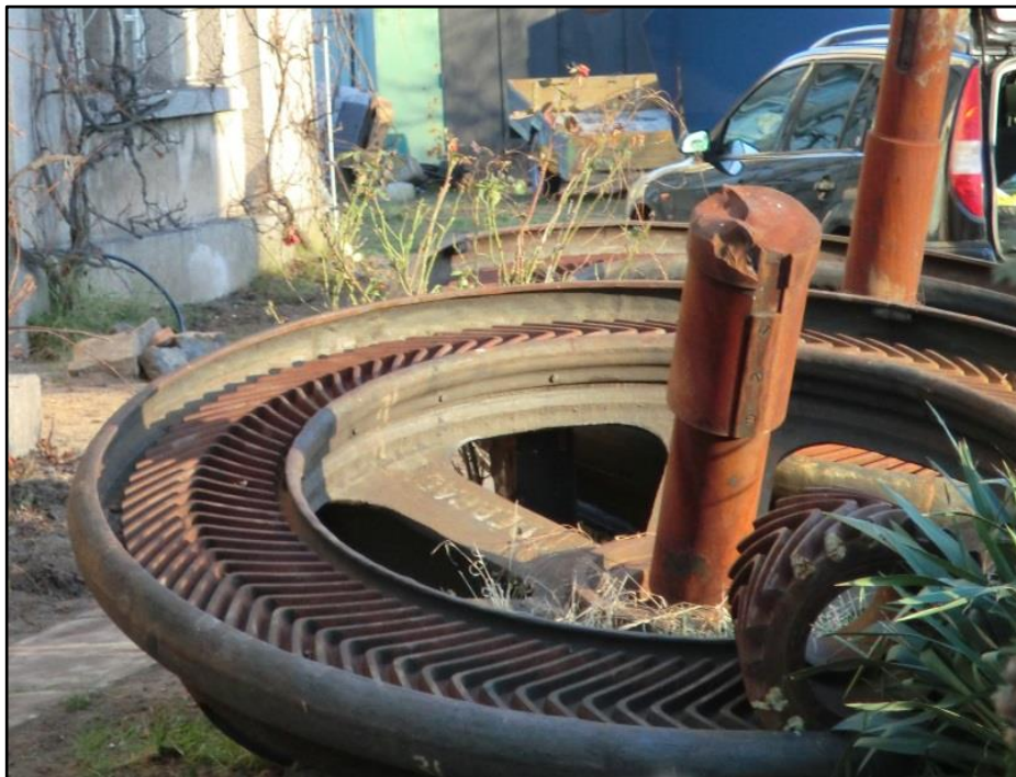
Obrázek 16 Původní ozubený Citroenův převod Foto M. Bubanec
