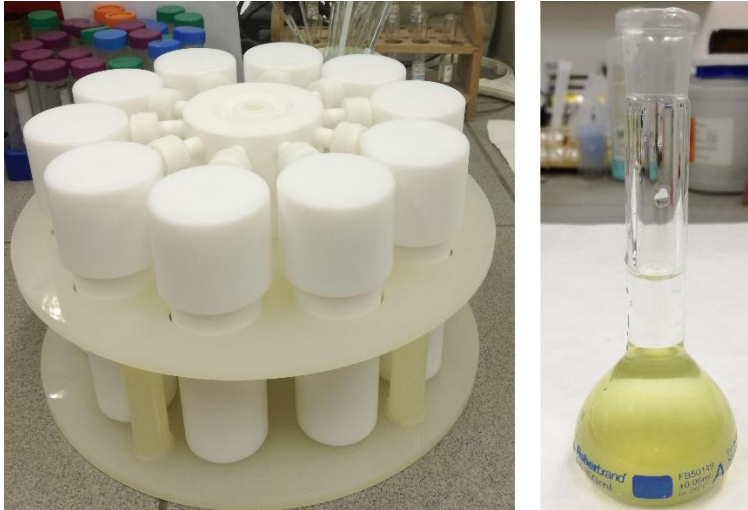
Obrázek 7: Vlevo-teflonové mineralizační nádoby po mineralizaci. Na obrázku vpravo je přefiltrovaný a zředěný vzorek, připravený k změření na spektrofotometru.
