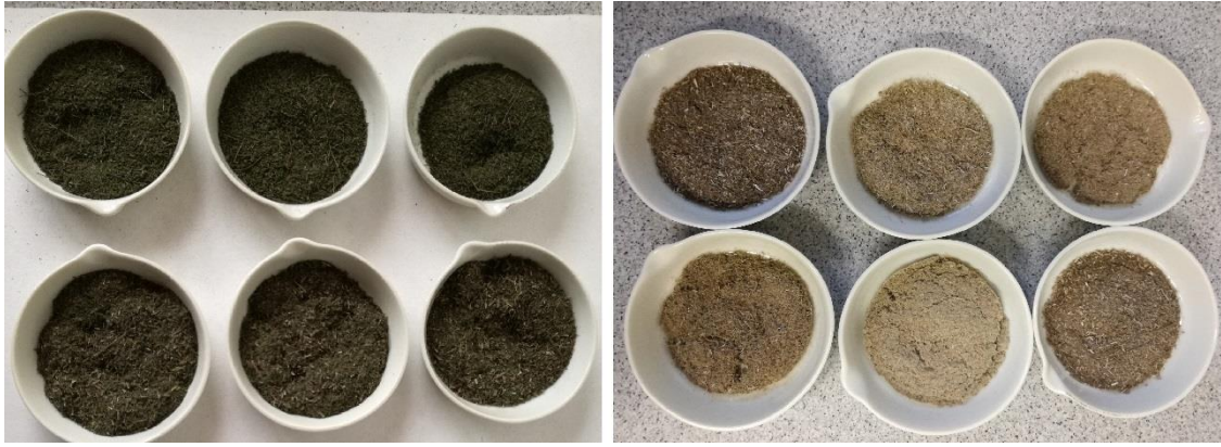
Obrázek 6: Stanovení celkového uhlíku v makrofytech. Na obrázku vlevo jsou vysušená (105 °C) a odvážená makrofyta (3 g). Na obrázku vpravo jsou po žihání v Muflově peci na 550 °C.
