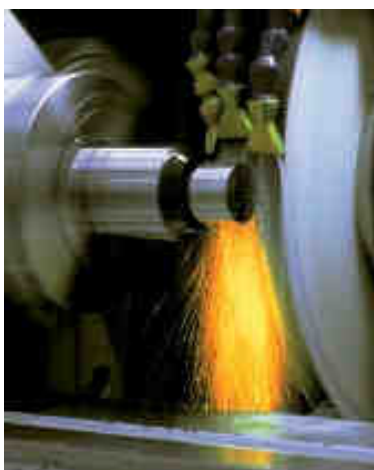
Obr. 3.9 Broušení povrchu válcové plochy při upnutí do sklíčidla na brusce Kellenberger 6
