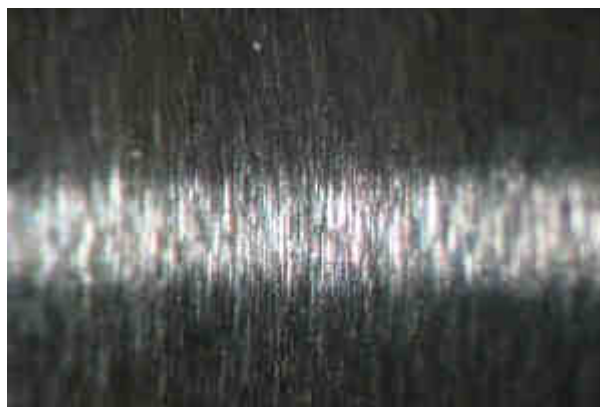
Obr. 4.1 Stopy na povrchu broušeného válce
