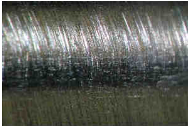
Obr. 4.5 Stopy na povrchu honovaného válce
