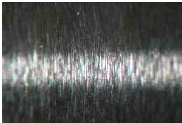
Obr. 4.1 Stopy na povrchu broušeného válce
