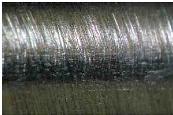
Obr. 4.5 Stopy na povrchu honovaného válce
