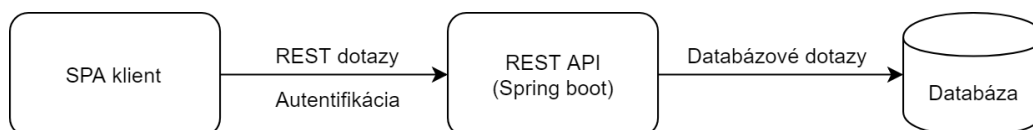
Obr. 2.3: Príklad architektúry single-page aplikácie s backend Spring Boot .
