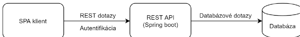
Obr. 2.3: Príklad architektúry single-page aplikácie s backend Spring Boot .
