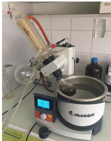
Obrázek 10 Odpařování extraktu na vakuové rotační odparce
