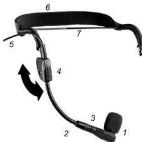
Obr. 23 Části mikrofonu WH30XLR
