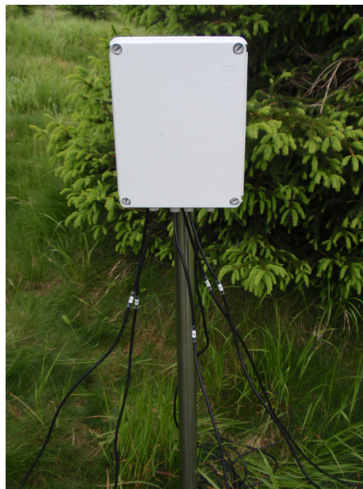
Obr. 4: Vlhkostní datalogger VIRRIBLOGGER od firmy AMET
