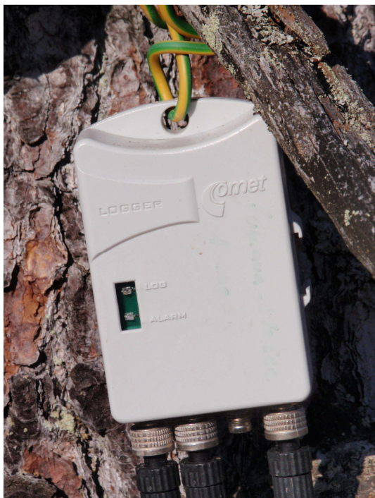
Obr. 5: Teplotní datalogger LOGGER R0110E od firmy Comet
