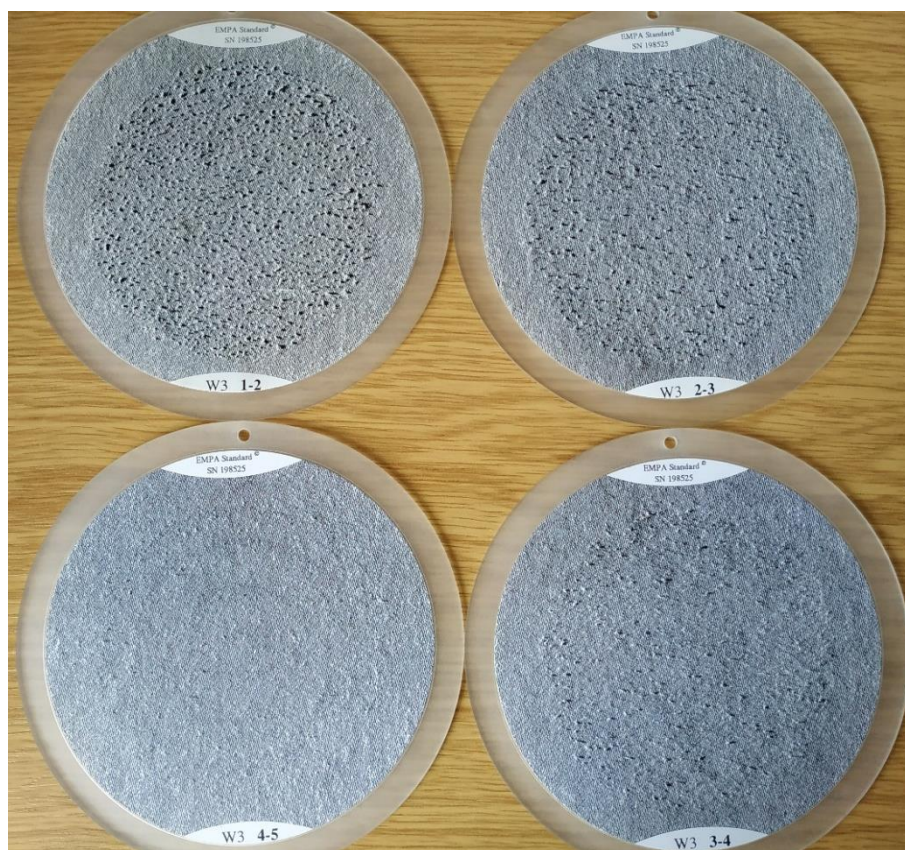
Obrázek 8: Ukázka etalonů pro Matryndale použitých při subjektivním hodnocení v praktické části práce. Zdroj vlastní.
