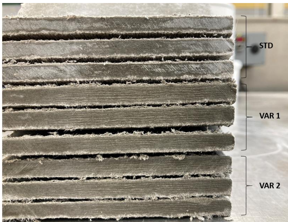
Obr.75: Delaminace jednotlivých vzorků při 5.cyklu mrazuvzdornosti v 3% roztoku NaCl
