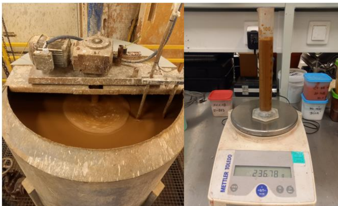
Obr.42: Odběr vzorků kalového odpadu z homogenizátoru a stanovení litrové hmotnosti [autor]
