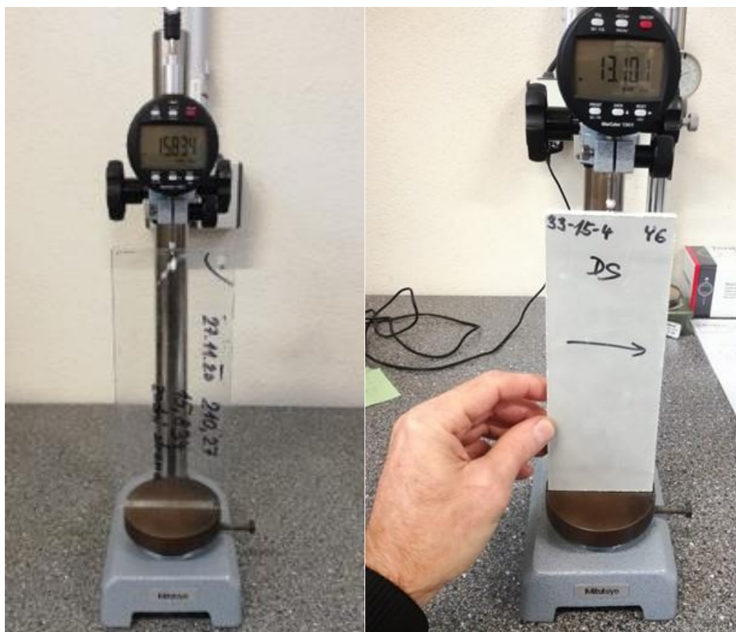
Obr.40: Kalibrace digitálního měřidla pomocí skleněné destičky a následné měření délky zkušební vzorku [90]
