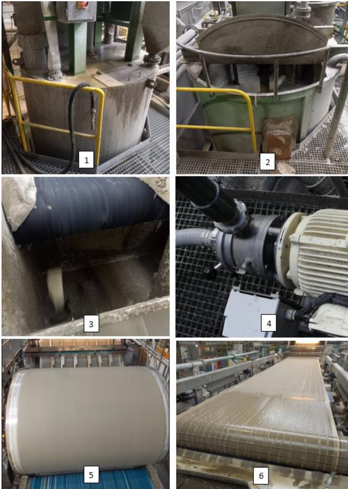
Obr.12: Pohled na Hatschekův výrobní stroj: 1-Tampela, 2-Míchačka, 3-Rozmělňovač, 4-Koloidní mlýn, 5-Formátový válec, 6-Mokrý část [autor]
