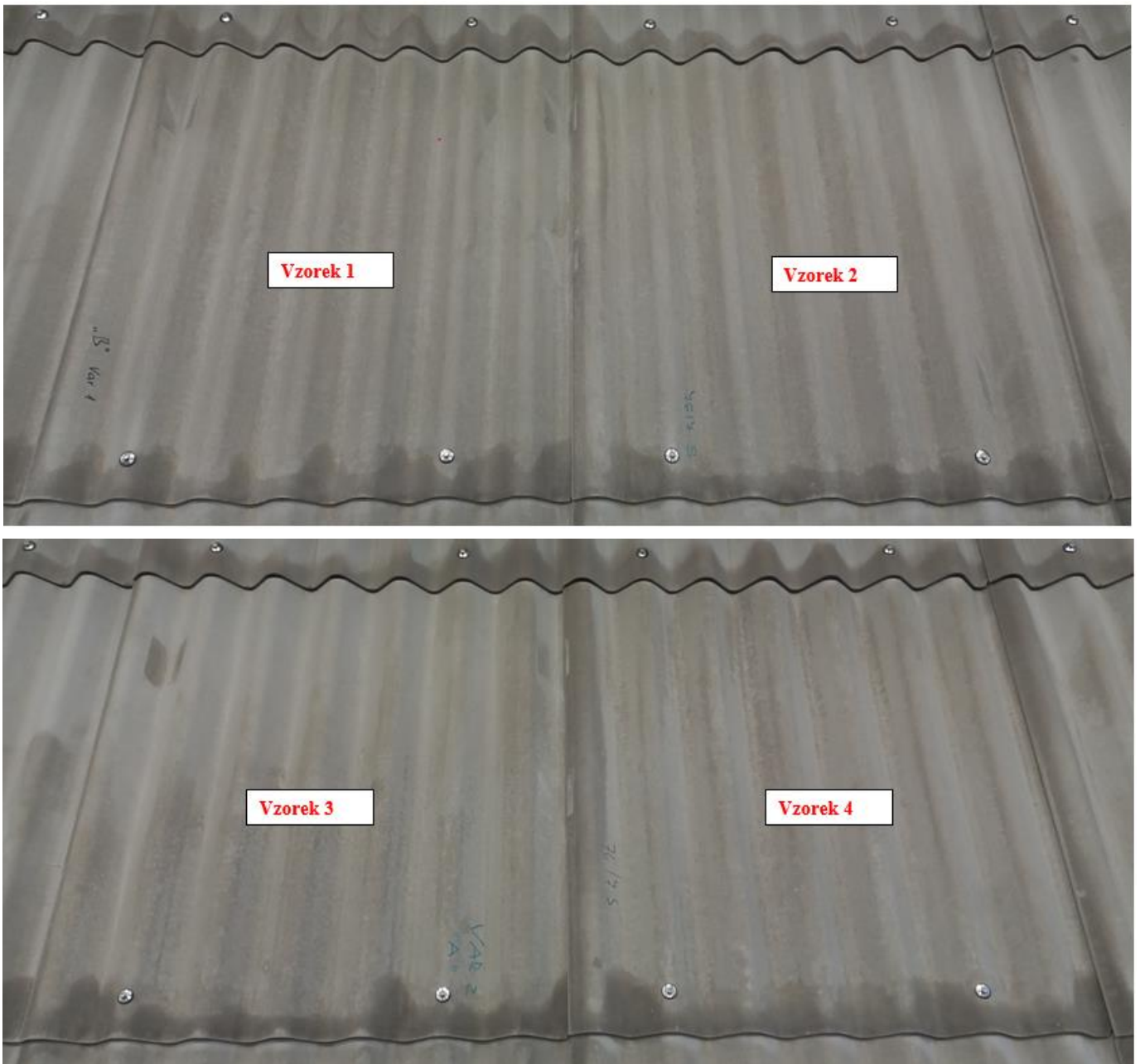
Obr.70: Lícová strana testovaných vlnovek po 50 cyklech
