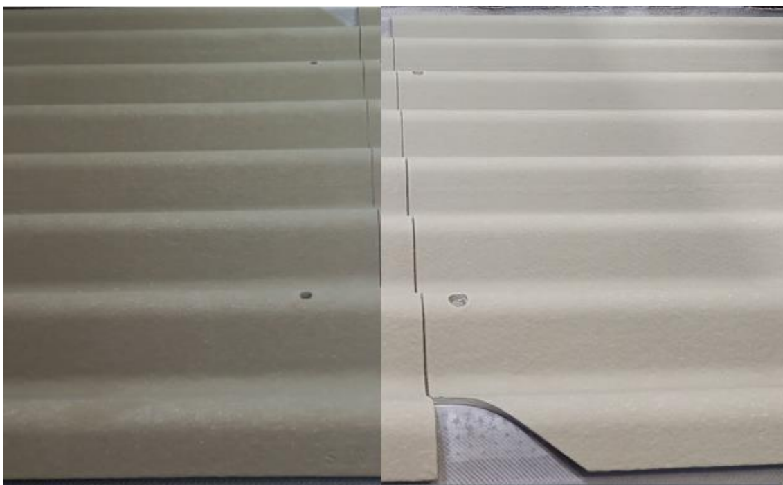
Obr.56: Povrch vylisovaných výrobků: vlevo – kalový odpad, vpravo – standardní břecha [autor]
