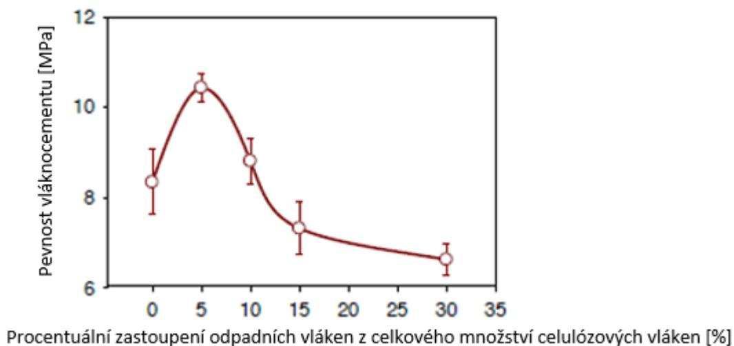
Obr.16: Vliv obsahu celulózy z odpadního kalu na výsledné pevnosti vláknocementu [64]
