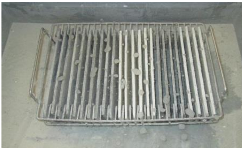
Obr.82: Namáčení zkušebních vzorků umístěných v rámu ve vodě
