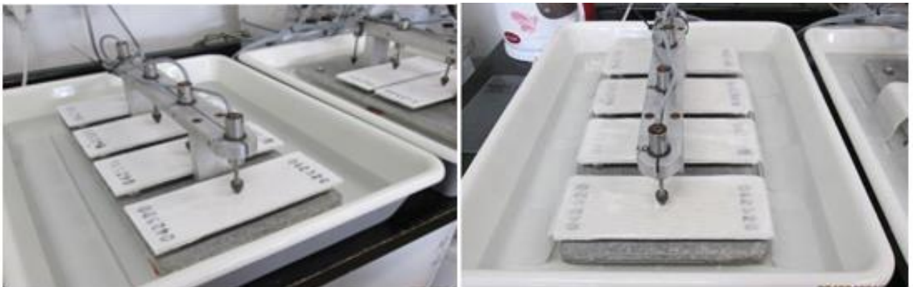
Obr.41: Sestava pro měření deformace vzorků působením vlhkosti (warping) [91]
