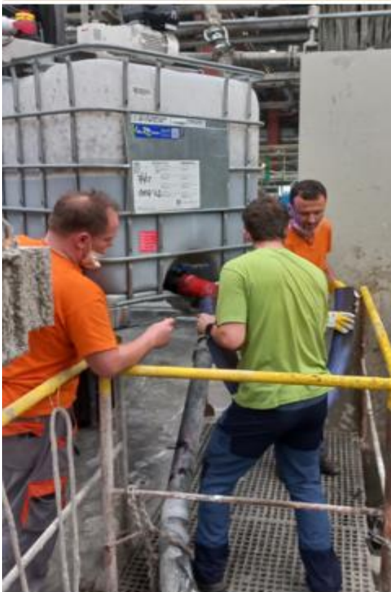
Obr.51: Odběr kalů do IBC kontejnerů, jejich míchání a dávkování do rozmělnovače
