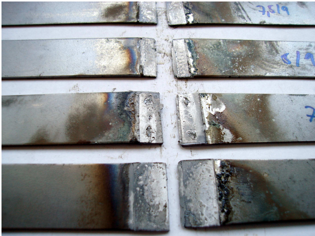
Obr. 30 Přetržené vzorky – ocelový plech
