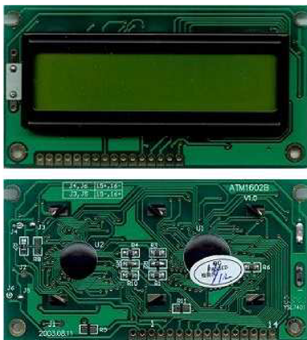
Obr. 4.1: Dvouřádkový zobrazovač MC160E-SYL/H (převzato z [7]).
