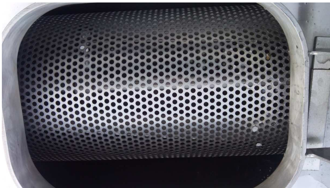
Obrázek 6: Pasírovací síto vně pracovního prostoru, odstředivý odpeckovač firmy DESTILA
