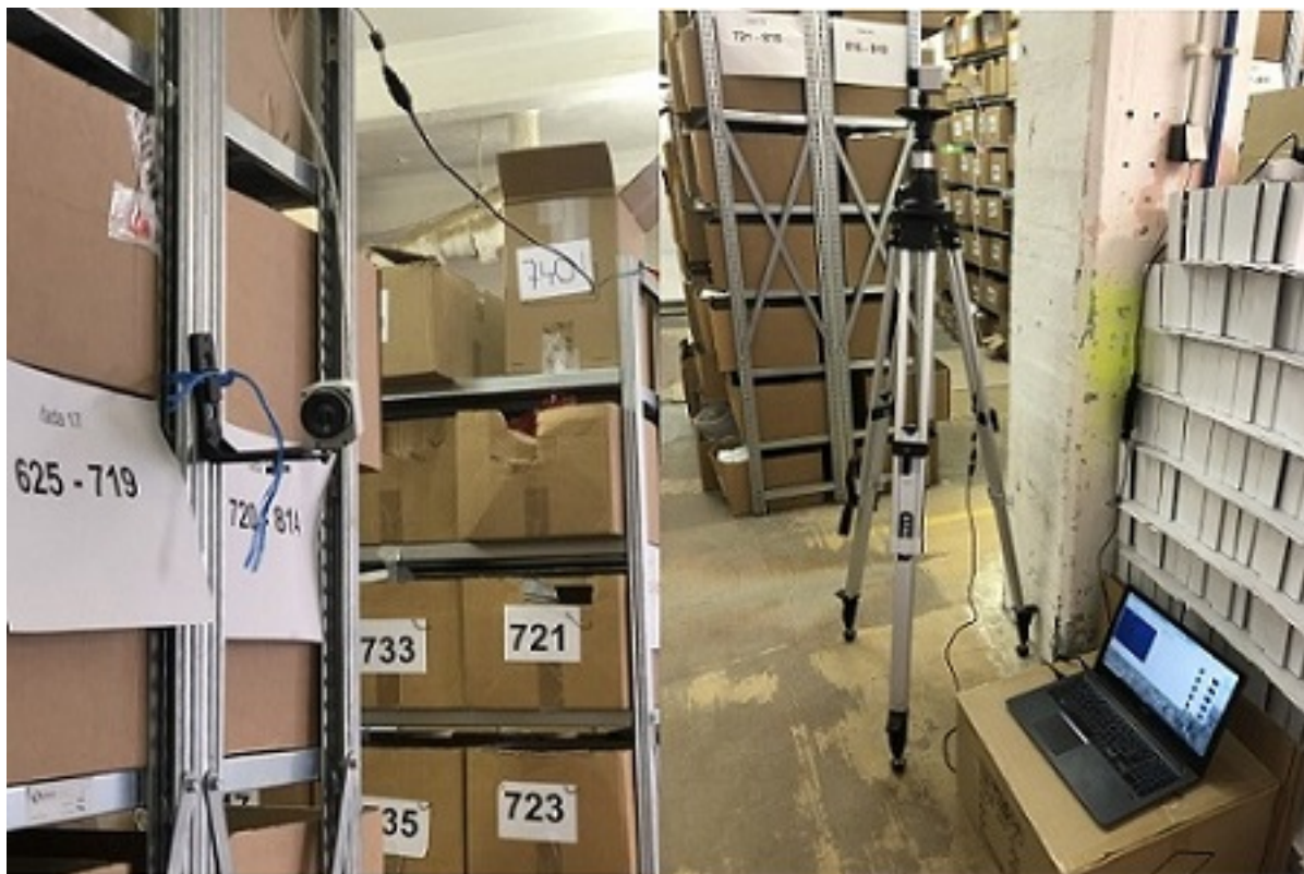
Obr. 3.4: Zber dát z termovíznej kamery v sklade
