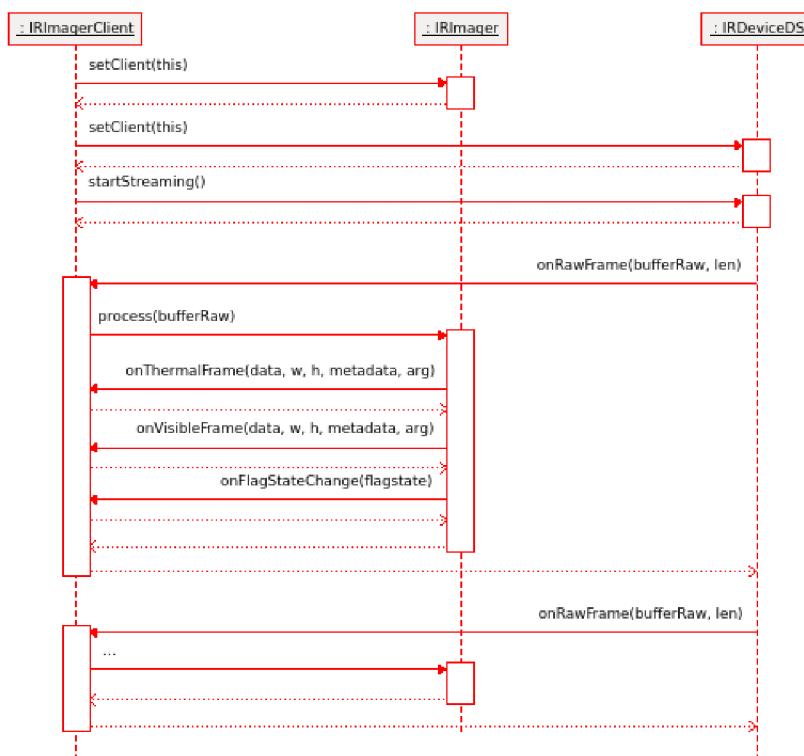
Obr. 3.1: Sekvenčný UML diagram získavania dát pomocou knižnice libirimager.lib [53]
