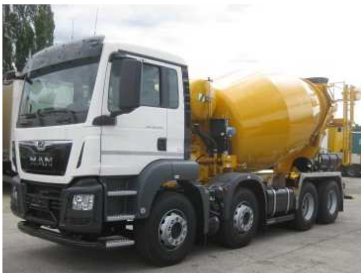
Obrázok H.9 – Autodomiešavač Man TGS 32.420 [22]
