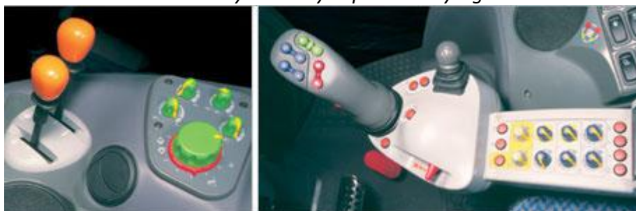
Obr. 11 Ovladače hydraulických prvků řady AgroTron TTV
