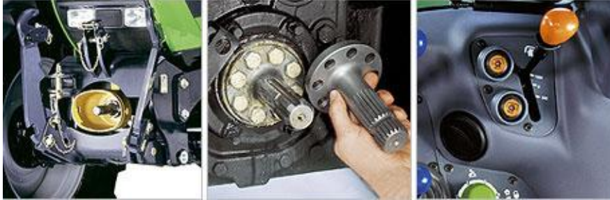
Obr. 12 Přední a zadní vývodový hřídel, páka pro změnu otáček
