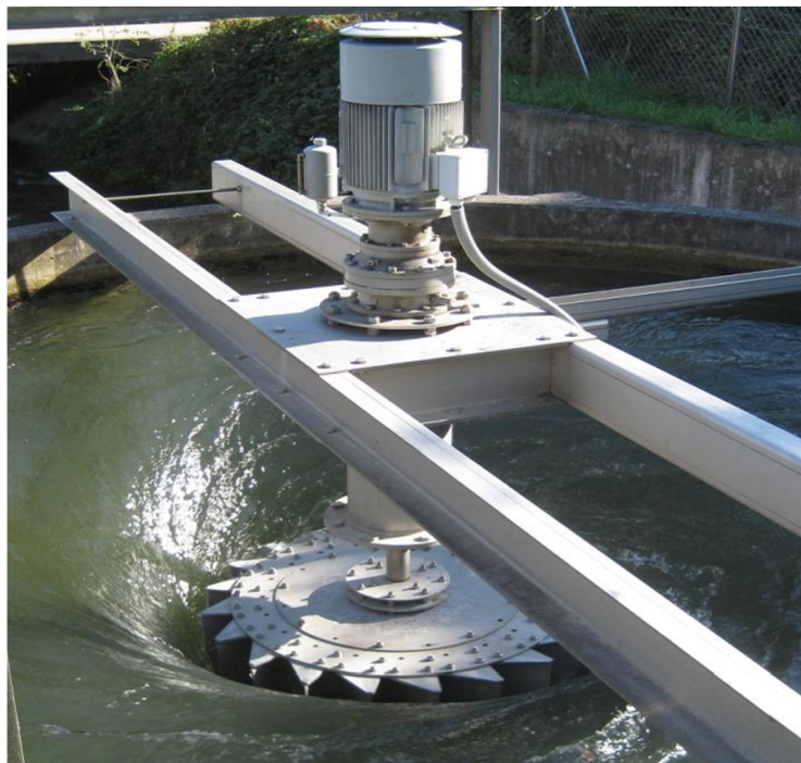
Obrázek č. 9 – Vírová vodní turbína v rakouském městě Ober-Grafendorf [69]
