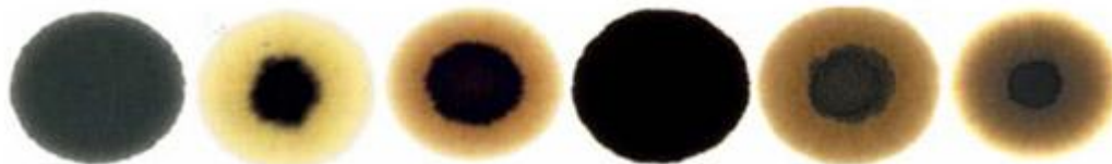
Obr. 3: Kapková zkouška a projevy znečištění motorových olejů
