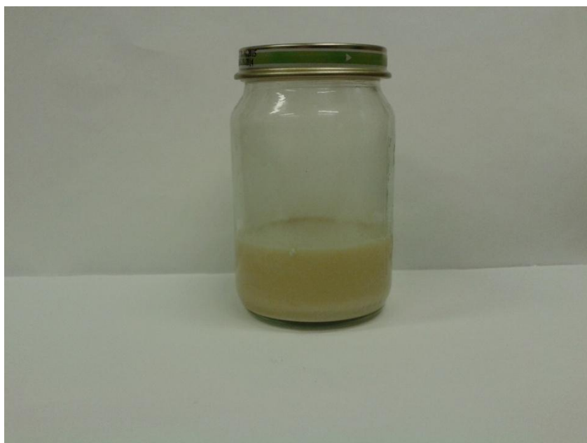
Obr. 6: Vzorek oleje o obsahem vody 10 % hm.
