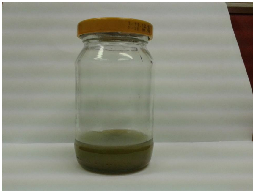
Obr. 7: Vzorek oleje s obsahem chladicí kapaliny G11 10 % hm.
