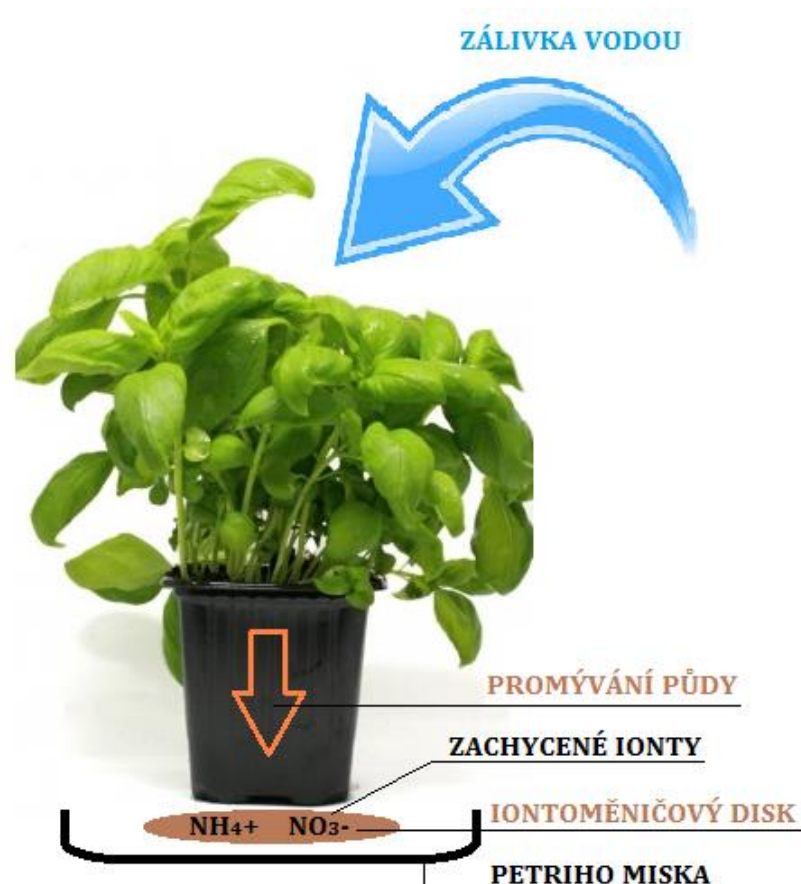
Obrázek 9: Schéma principu vyplavování minerálního dusíku
