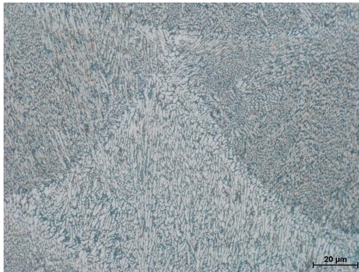
Obr. 44: Mikrostruktura SLM buňky s patrnými kolumnárními zrny a jemnozrnnou fúzní hranicí slitiny 75 hm. % AlSi12 + 25 hm. % 2618, příčný řez „T“
