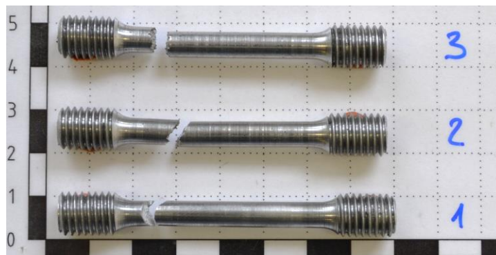
Obr. 62: Vzorky po tahové zkoušce slitiny 50 hm. % AlSi12 + 50 hm. % 2618
