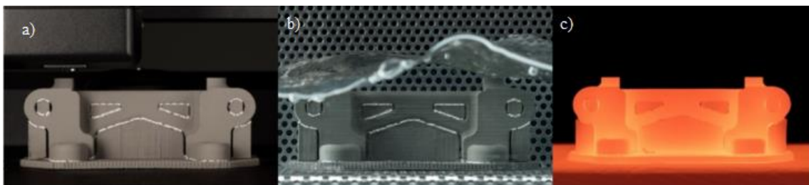
Obr. 5: Metoda BMD a) 3D – tisk modelu, b) odstranění primárního pojiva, c) slinování v peci [9]
