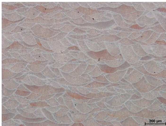
Obr. 41: Mikrostruktura slitiny 75 hm. % AlSi12 + 25 hm. % 2618, podélný řez „L“
