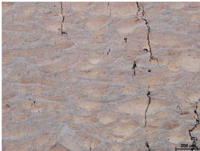
Obr. 69: Mikrostruktura slitiny 25 hm. % AlSi12 + 75 hm. % 2618 s trhlínami překonávajícími více vrstev, příčný řez „T“
