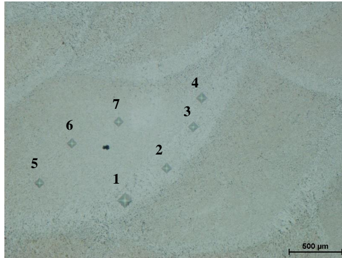
Obr. 66: Umístění vtisků HV 0,01, slitina 50 hm. % AlSi12 + 50 hm. % 2618
