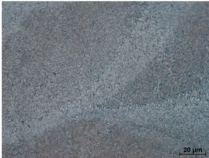
Obr. 55: Detail fúzních hranic slitiny 50 hm. % AlSi12 + 50 hm. % 2618, podélný řez „L“
