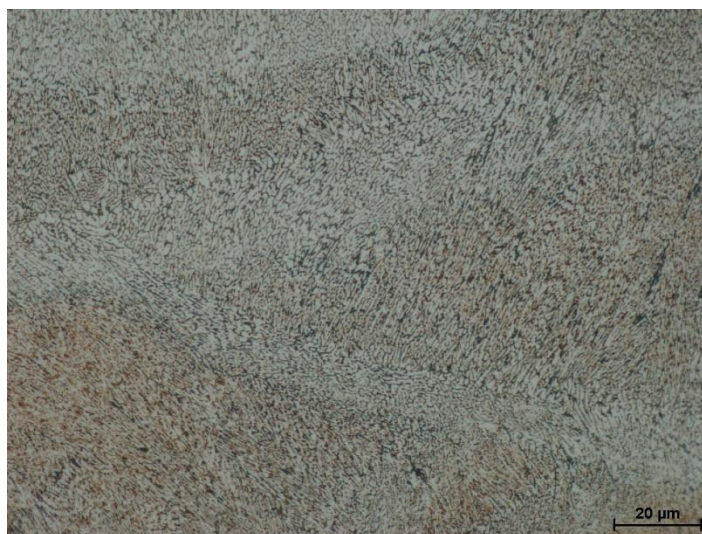
Obr. 57: Detail fúzních hranic s navazujícími kolumnárními zrny slitiny 50 hm. % AlSi12 + 50 hm. % 2618, příčný řez „T“
