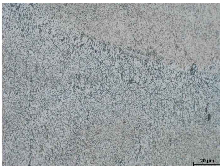
Obr. 70: Detail fúzní hranice slitiny 25 hm. % AlSi12 + 75 hm. % 2618, příčný řez „T“
