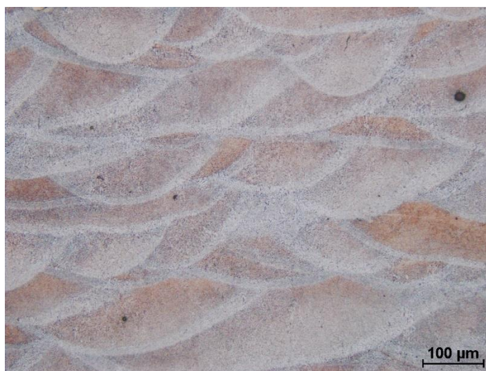
Obr. 54: Mikrostruktura slitiny 50 hm. % AlSi12 + 50 hm. % 2618, podélný řez „L“
