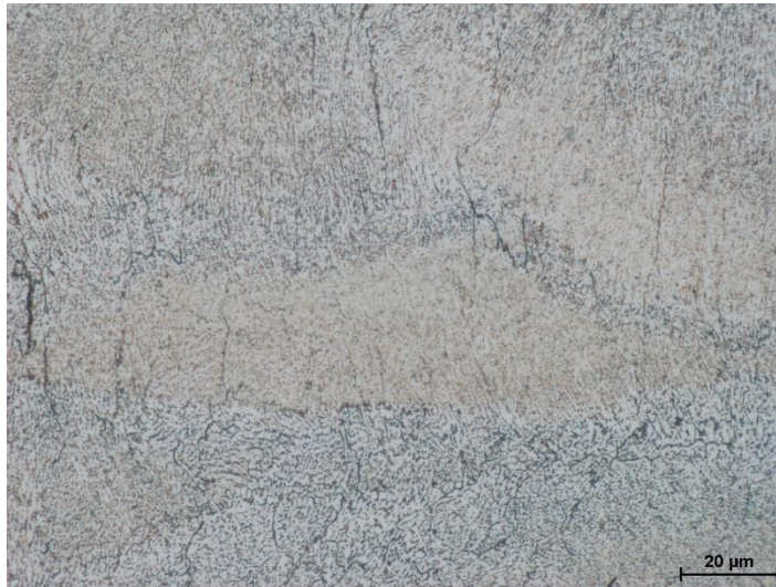
Obr. 68: Mikrostruktura slitiny 25 hm. % AlSi12 + 75 hm. % 2618, s trhlínami podél kolumnárních zrn i v oblasti fúzních hranic, podélný řez „L“
