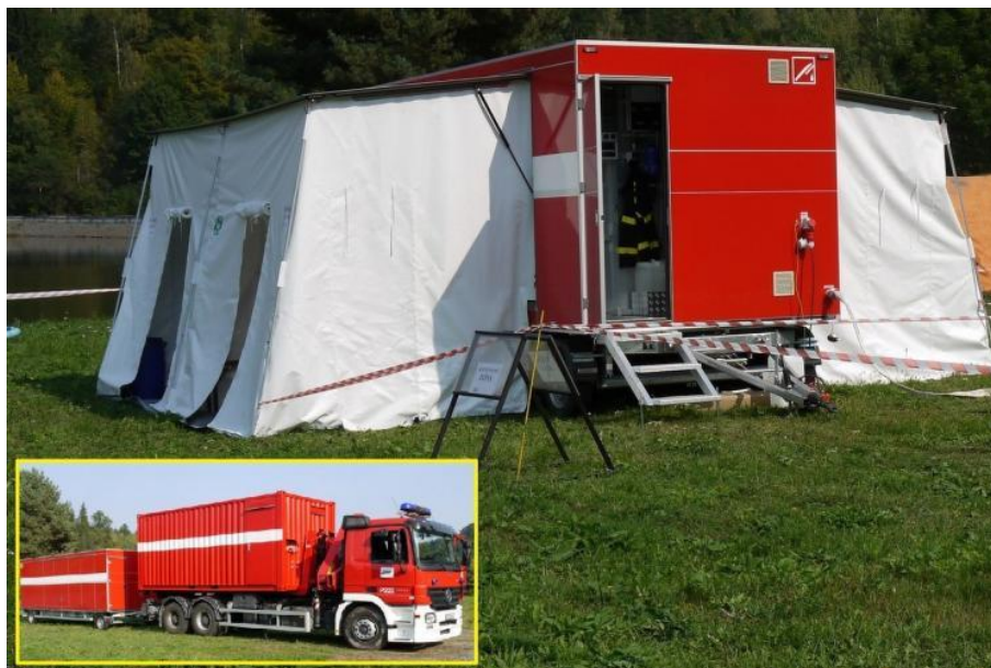
Obrázek č. 3: SDO 3 v pohotovostním a transportním režimu (zdroj ZÚ HZS Hlučín)
