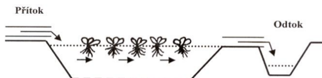
Obr. 12 Schématické znázornění umělého mokřadu s plovoucí vegetací (Vymazal, 2004)
