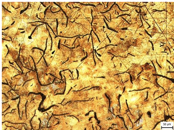
Obr. 5.4.2 Metalografický výbrus vzorku litiny GJL-300 Cu v litém stavu.
