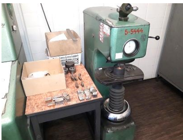
Obr. 4.2 Měření tvrdosti na stacionárním Brinellově tvrdoměru ve Slévárně Heunisch.
