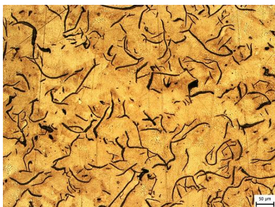
Obr. 5.5.2 Metalografický výbrus vzorku litiny GJL-300 Cr v litém stavu.
