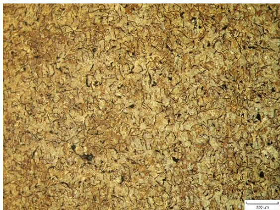
Obr. 6.3.2 Metalografický výbrus vzorku z GJL-250 Sn bez tepelného ovlivnění.
