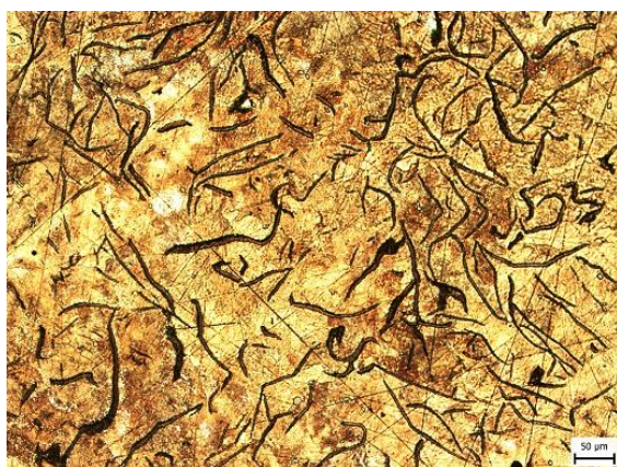
Obr. 5.1.2 Metalografický výbrus vzorku litiny GJL-200 v litém stavu.
