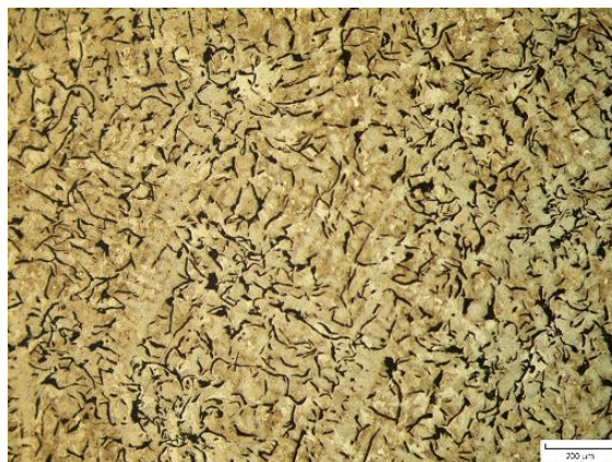
Obr. 6.7.3 Metalografický výbrus vzorku z GJL-300 CuCr po 6 hod v peci při teplotě 650 °C.
