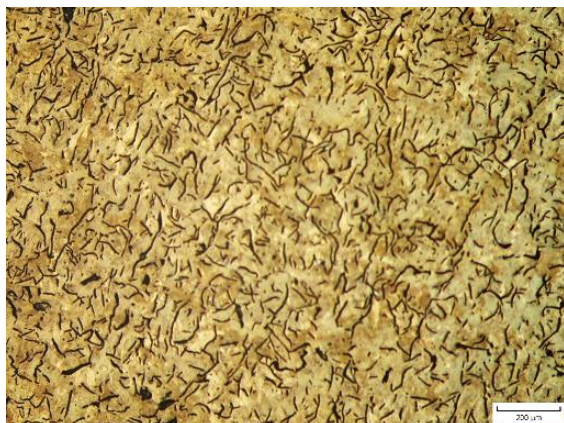
Obr. 6.5.2 Metalografický výbrus vzorku z GJL-300 Cu bez tepelného ovlivnění.
