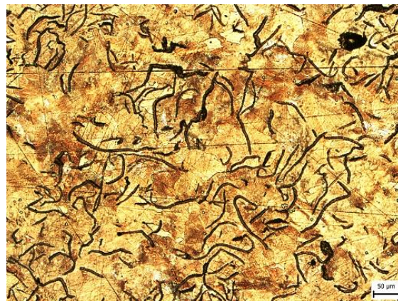
Obr. 5.4.3 Metalografický výbrus vzorku litiny GJL-300 Cu po tepelném cyklu.
