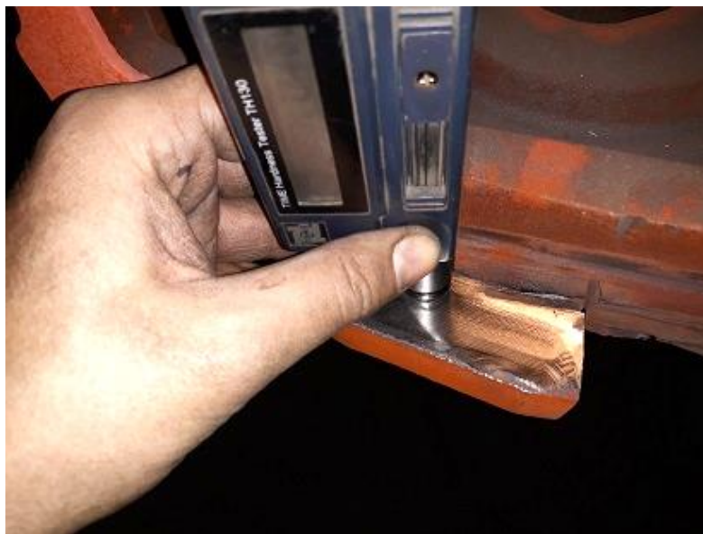
Obr. 4.1 Měření tvrdosti pomocí Shoreho tvrdoměru TIME Hardness Tester TH130.
