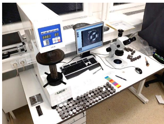
Obr. 4.4 Pracoviště pro měření tvrdosti dle Brinella na Ústavu materiálového inženýrství FSI VUT v Brně.
