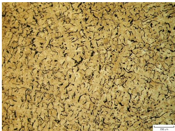
Obr. 6.7.2 Metalografický výbrus vzorku z GJL-300 CuCr bez tepelného ovlivnění.
