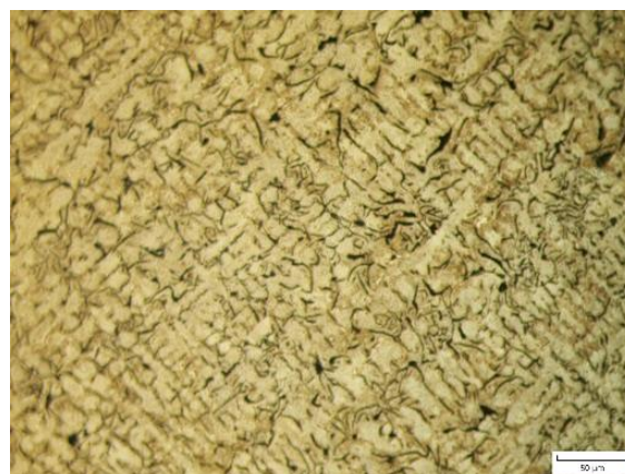
Obr. 6.6.3 Metalografický výbrus vzorku z GJL-300 Cr po 6 hod v peci při teplotě 650 °C.
