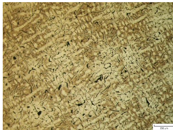
Obr. 6.3.3 Metalografický výbrus vzorku z GJL-250 Sn po 6 hod v peci při teplotě 650 °C.
