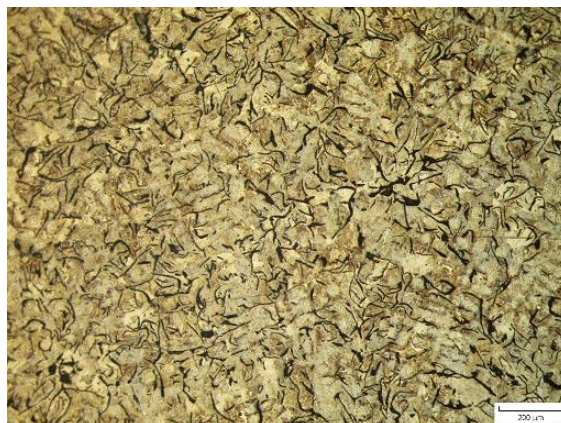
Obr. 6.9.3 Metalografický výbrus vzorku z GJL-300 Sn po 6 hod v peci při teplotě 650 °C.
