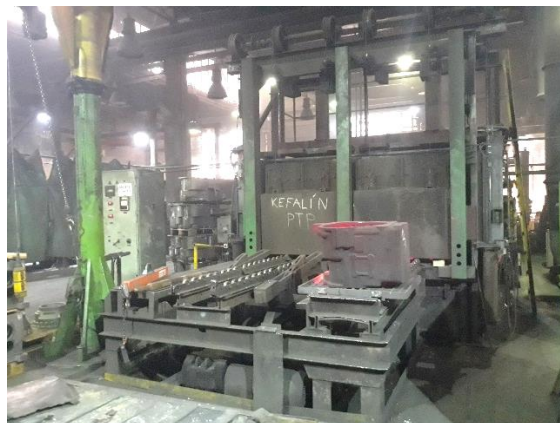
Obr. 3.3b Průběžná předehřívací pec z pohledu pracoviště zavařování za tepla B .
