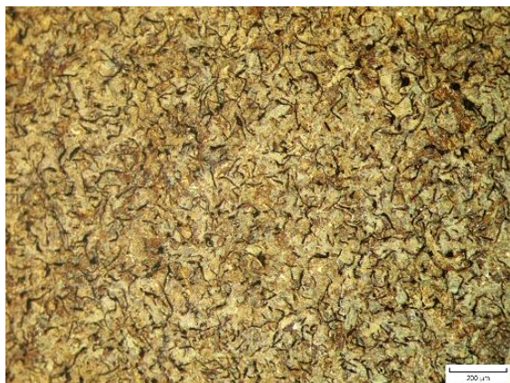
Obr. 6.9.2 Metalografický výbrus vzorku z GJL-300 Sn bez tepelného ovlivnění.
