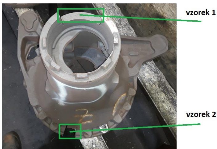
Obr. 5.7.1 Odlitek M 416 150 130 s vyznačením míst odběru vzorků.
