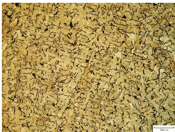
Obr. 6.6.2 Metalografický výbrus vzorku z GJL-300 Cr bez tepelného ovlivnění.
