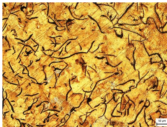
Obr. 5.2.3 Metalografický výbrus vzorku litiny GJL-250 po tepelném cyklu.
