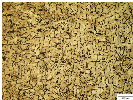
Obr. 6.5.3 Metalografický výbrus vzorku z GJL-300 Cu po 1,5 hod v peci při teplotě 650 °C.
