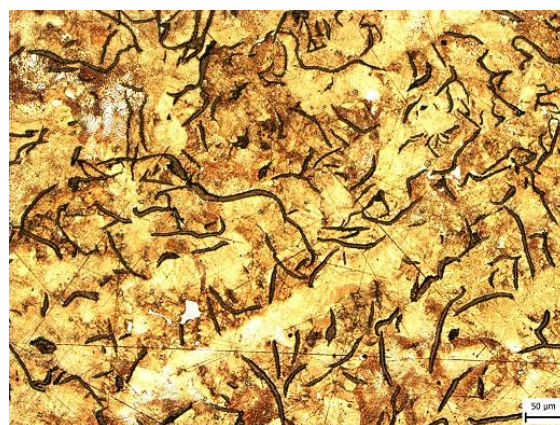
Obr. 5.5.3 Metalografický výbrus vzorku litiny GJL-300 Cr po tepelném cyklu.
