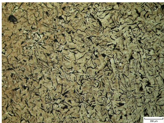
Obr. 6.1.2 Metalografický výbrus vzorku z GJL-200 bez tepelného ovlivnění.
