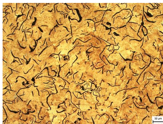
Obr. 5.3.3 Metalografický výbrus vzorku litiny GJL-300 po tepelném cyklu.
