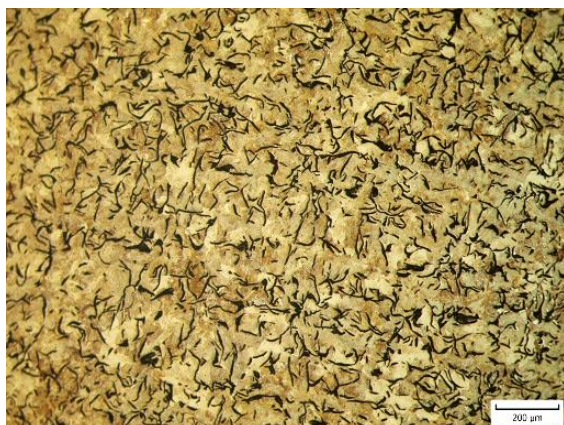
Obr. 6.4.4 Metalografický výbrus vzorku z GJL-300 Cu po 3 hod v peci při teplotě 650 °C.
