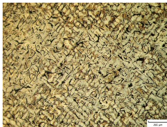
Obr. 6.4.3 Metalografický výbrus vzorku z GJL-300 po 6 hod v peci při teplotě 650 °C.
