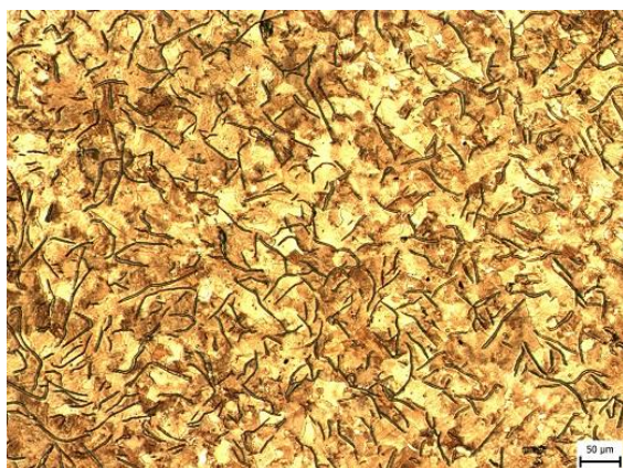
Obr. 5.6.2 Metalografický výbrus vzorku litiny GJL-300 CuCr v litém stavu.
