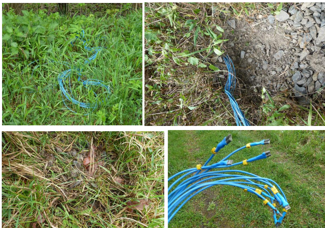
Obr. 4.12 Měřicí místa a stav obnažené kabeláže pro přenos signálů ze sond v roce 2016 – návodní líc, vpravo vzdušní líc (Koudelková)
