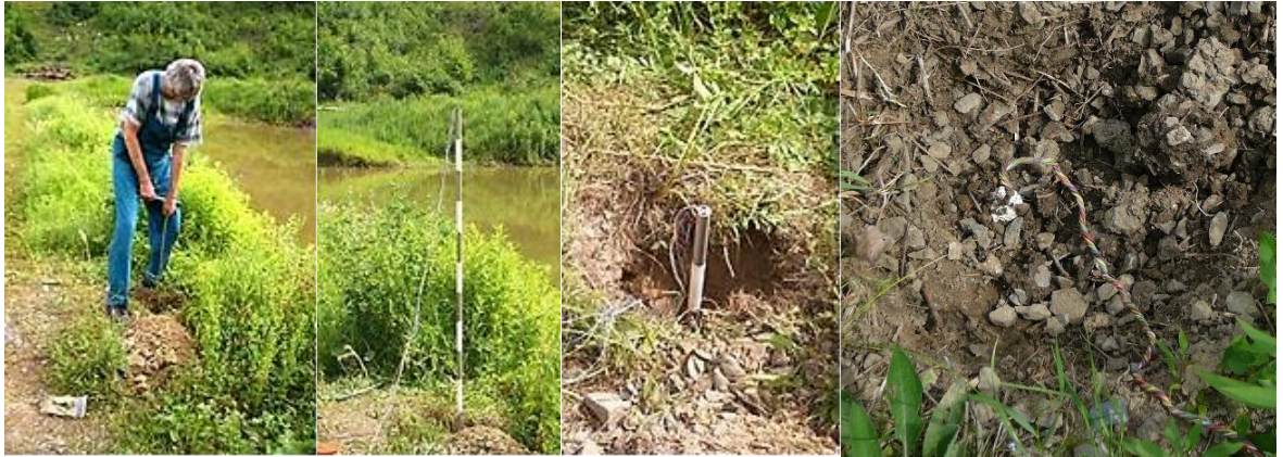
Obr. 4.10 Manuální instalace dělených trubicových sond (Pařílková, 2006)
