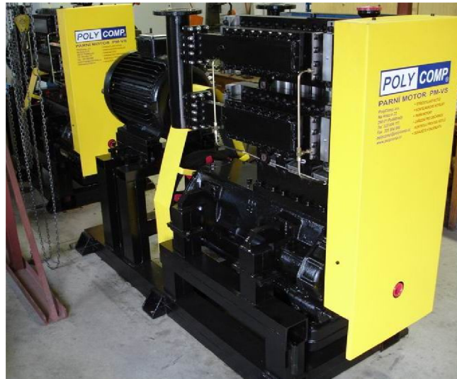
Obrázek 2- 1: Moderní parní stroj pro redukci páry Pramen: [8] Vlastní zpracování
