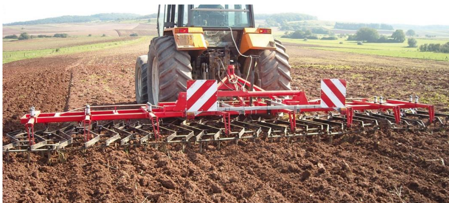
Obrázek 14 Těžké brány (Quivogne, 2020)
