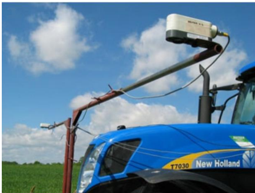
Obr. 2 Senzory Crop Circle™ pro blízké snímání hladiny dusíku v porostu (Diacono et al. 2012)
