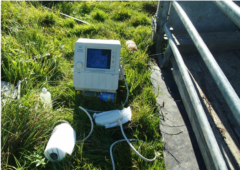
Obrázek č. 4: Aloka 500 (Hitachi Aloka Medical, Ltd.; Tokyo Japan) a 3,5 MHz lineární sonda (UST-5011U)
