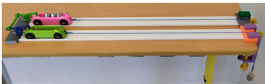
Paralelní sestavení souprav: startovací moduly propojené startovací příčkou, pojezdové lišty, vozíky, lanka, držáky kladky připravené pomocí svěrek.
