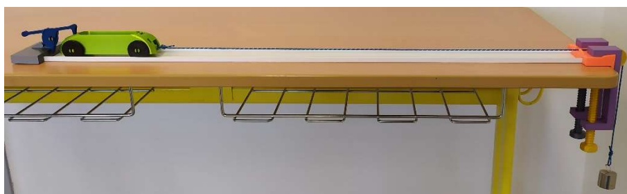
Sestavení soupravy: startovací modul, pojezdová lišta, vozík, lanko, držák kladky připevněný pomocí svěrek.
