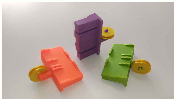
Obrázek 21: Vytisknutý držák kladky s osazenou kladkou.
