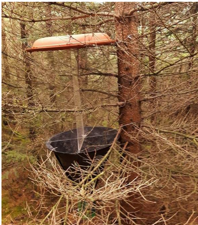
Obr. č. 6 – Past č. 5, v porostech po zapojení jsou zhoršené letové podmínky pro hmyz i manipulace a doplnění fixační tekutiny
