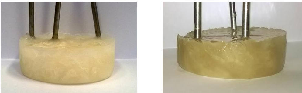
Obr. 31: Vlevo fázová přeměna při vkládaném napětí 14 V, vpravo fázová přeměna při vkládaném napětí 16 V
