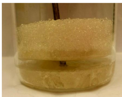
Obr. 26: Fázová přeměna při vkládaném napětí 12 V po dobu 96 h.
