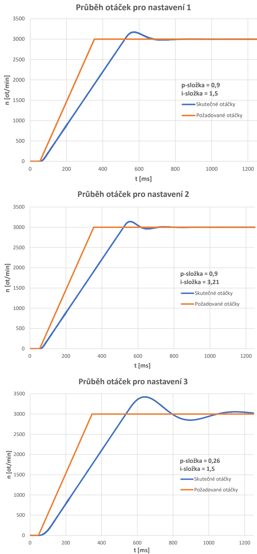
Obr. 34: Průběhy otáček servopohonu Kollmorgen pro nastavení 1 až 3
