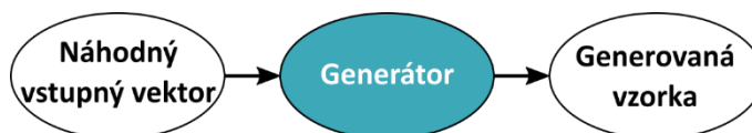
Obr. 2.7: Bloková schéma generátoru v GAN. Do generátoru vstupuje náhodný vektor (napríklad z Gaussovského rozloženia) a úlohou generátoru je vygenerovať novú vzorku, ktorá bude čo najviac pripomínať reálnu vzorku (z tréningových dát).
