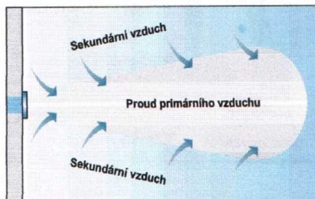
Obr. 1.11 Primárny vzduch s vyššou rýchlosťou [9]
