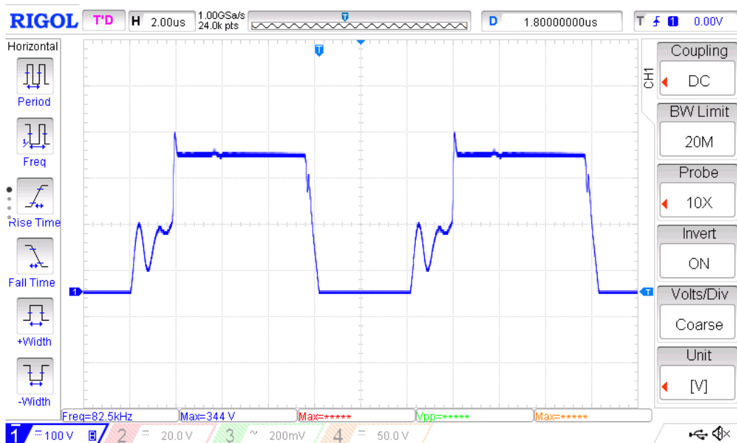
Obr. 6-5 Průběh napětí na usměrňovací diodě s RC článkem při plném zatížení
