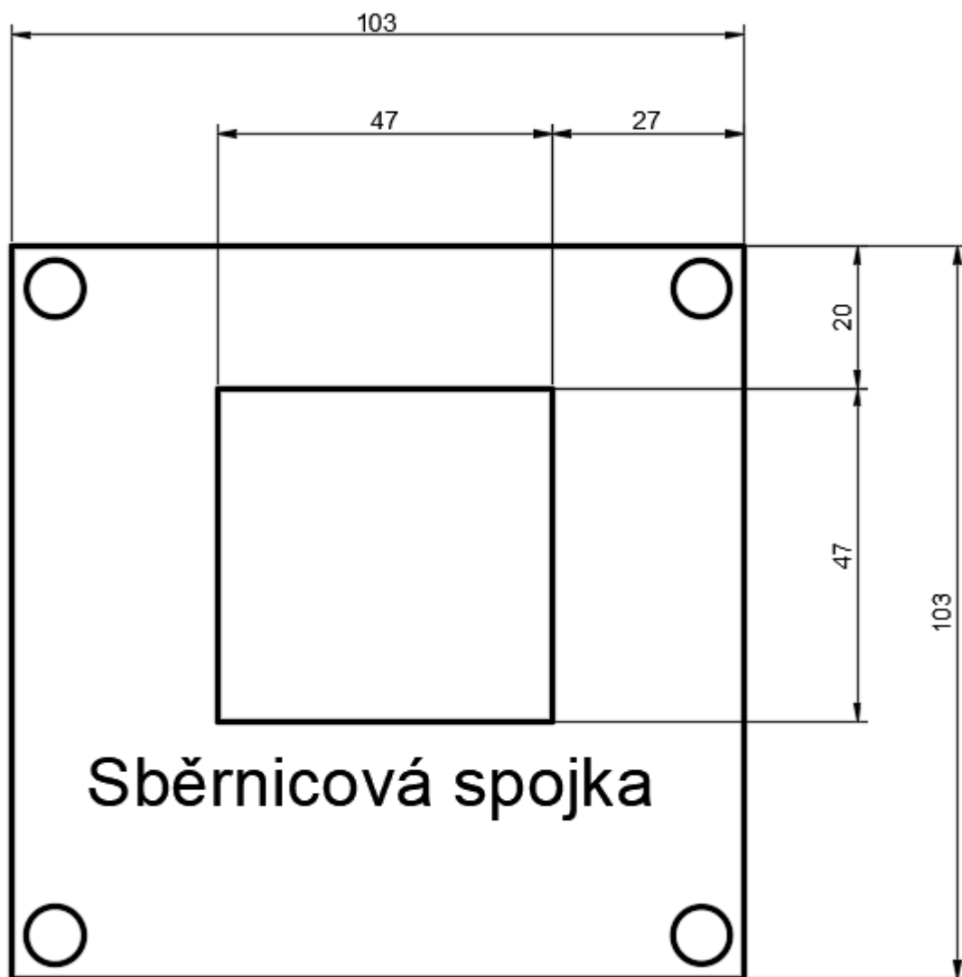
Obrázek 3.13 Šablona pro výrobu krabičky pro sběrníkovou spojku
